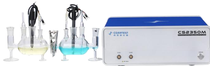
图2.金属中氢扩散控制
