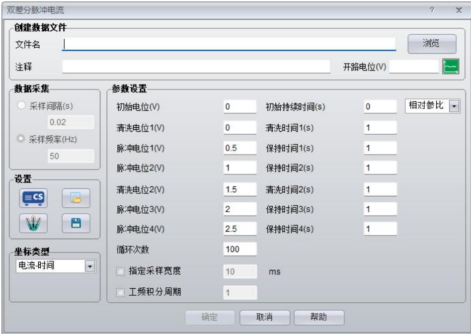
图 3.60 双差分脉冲电流检测法
