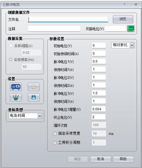
图 3.62 三脉冲电流检测
