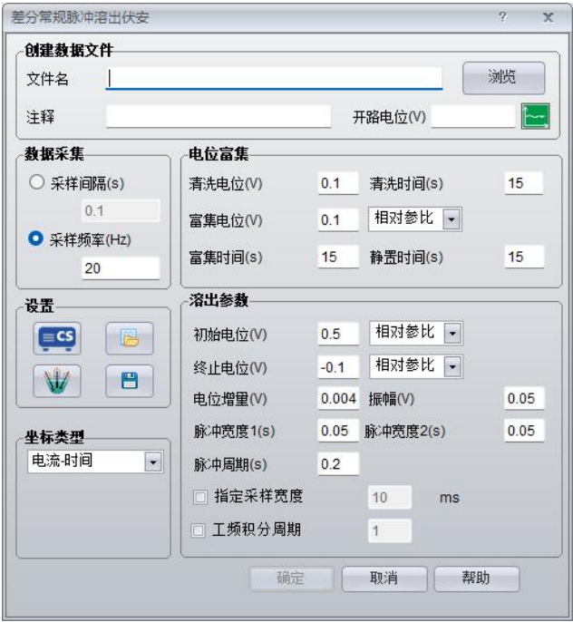
图 3.73 差分常规脉冲溶出伏安
