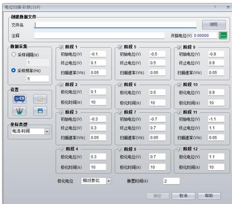
图 3.23 电位扫描阶跃参数设置窗口
