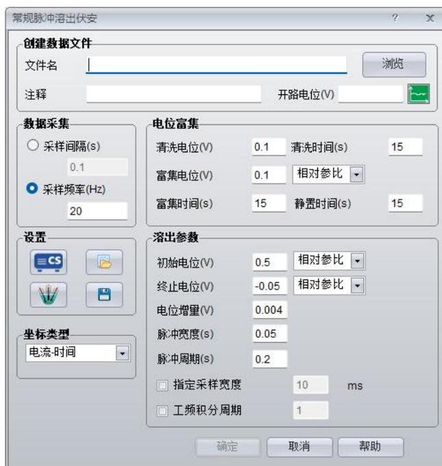
图 3.72 常规脉冲溶出伏安
