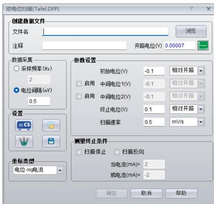
图 3.20 动电位扫描参数设置界面
