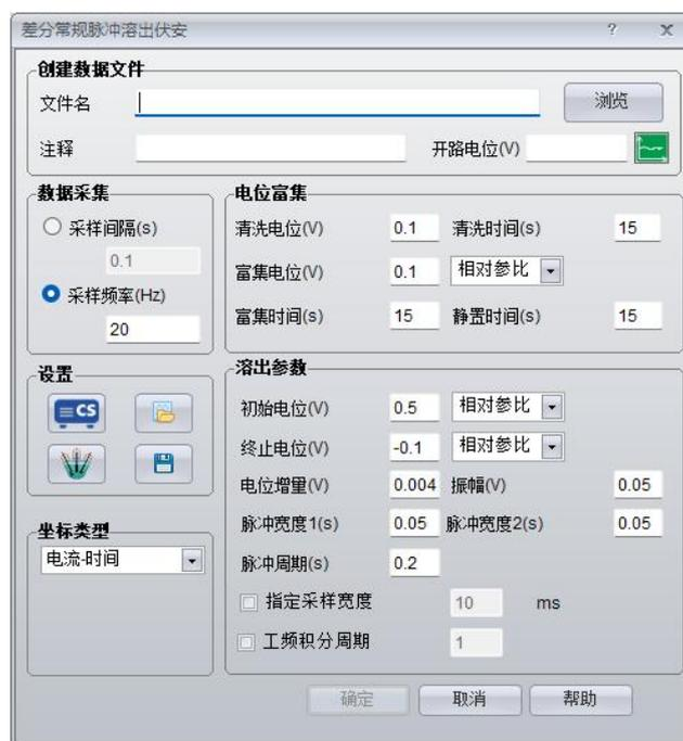
图 3.73 差分常规脉冲溶出伏安
