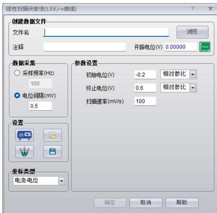
图 3.33 线性扫描伏安法参数设置界面
