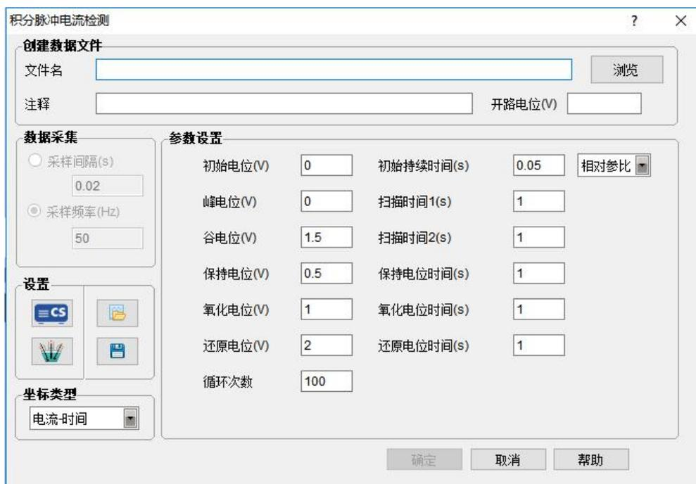
图 2.66 积分脉冲电流检测参数设置窗口
