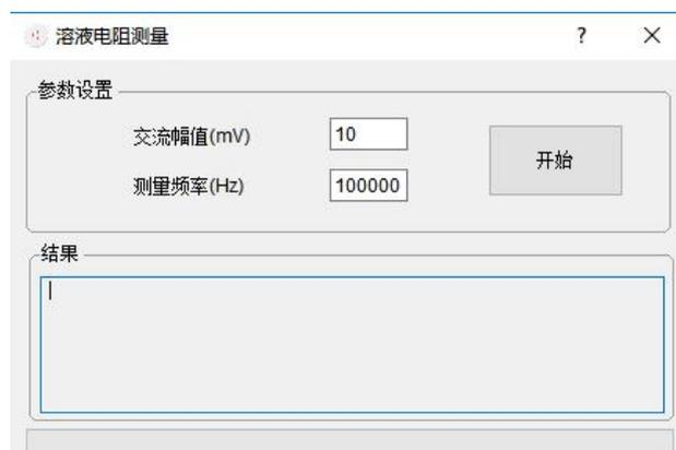
图 2.94 溶液电阻测试参数设置界面
