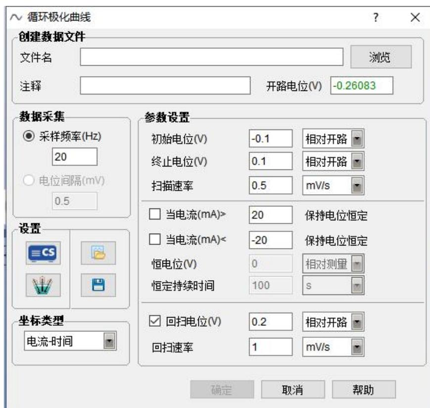
图 2.95 循环极化曲线测试参数设置界面
