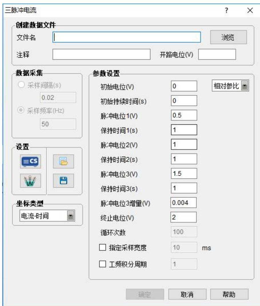
图 2.64 三脉冲电流检测参数设置窗口
