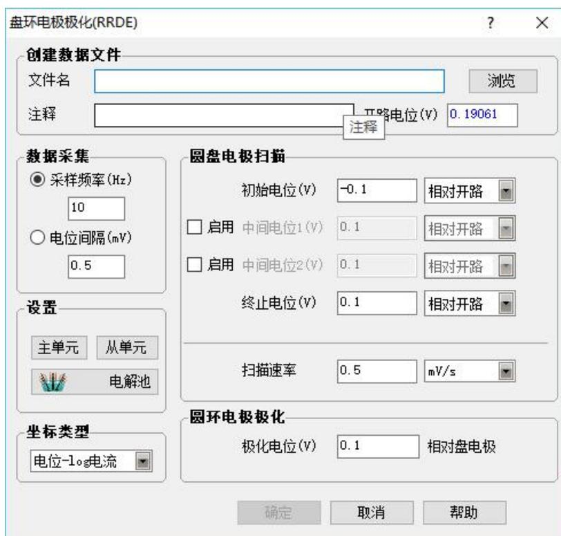
图 2.88 盘环电极测试参数设置窗口
