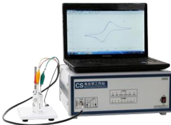
CS 系列工作站内置 DDS 和双路信号相关积分电路，提高了交流阻抗的测量精度，测试频率范围为 1MHz~10μHz，可以自动进行开路电位下或任意直流偏压下的电化学阻抗测试，内置直流偏置补偿电路可有效地提高交流信号的测量精度。激励正弦波的幅值可以在 0~±2.5V 范围内进行任意设定。阻抗测试输出的数据格式与 ZView 兼容，可以直接调用 ZView 进行阻抗谱分析。CS350H 电化学工作站还可输出正弦波、方波、三角波、锯齿波、脉冲波等，输出频率 0~100KHz。CS 系列仪器均具有按设定时间间隔自动定时测量的功能。
