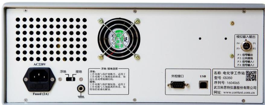
图 1.2 CS 系列工作站后面板电源及接口
