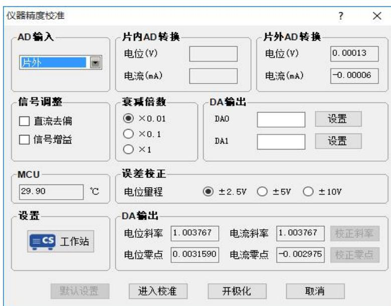
图 2.5 工作站的精度校准界面
