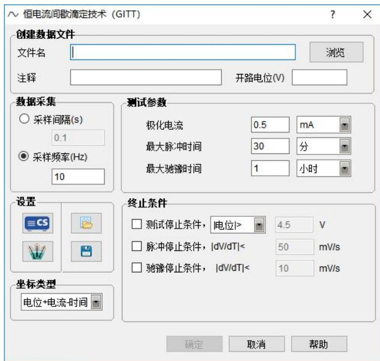
图 2.83 恒电流间歇滴定技术参数设置窗口
