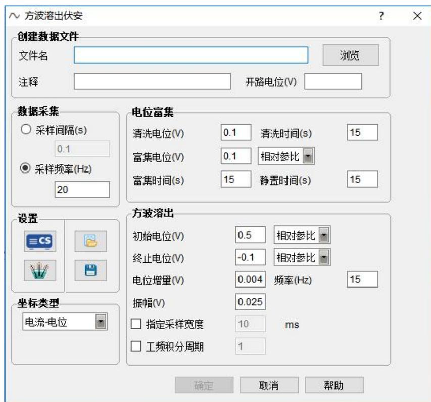
图 2.71 方波溶出伏安参数设置窗口
