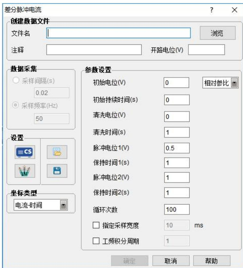
图 2.60 差分脉冲电流检测参数设置窗口
