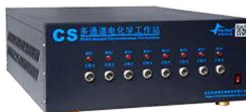
多通道电化学工作站（左图为四通道，右图为八通道）
